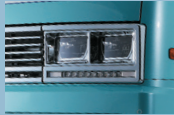
■LEDヘッドライト(角型4灯)・ デイトタイム・ランニング・ランプ
